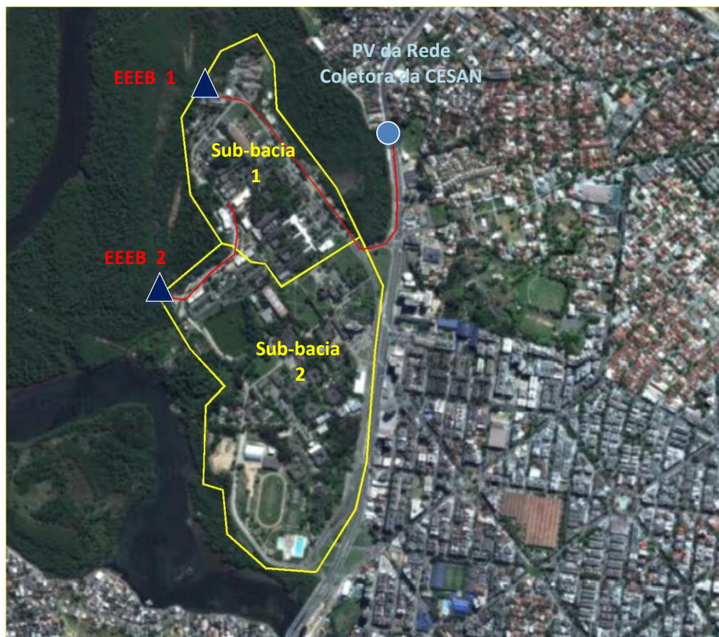
Figura 2 - Concepção do sistema de esgotamento sanitário projetado.
