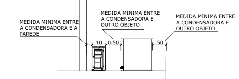
DET. INST. CONDENSADORAS - VISTA LATERAL SEM ESCALA
